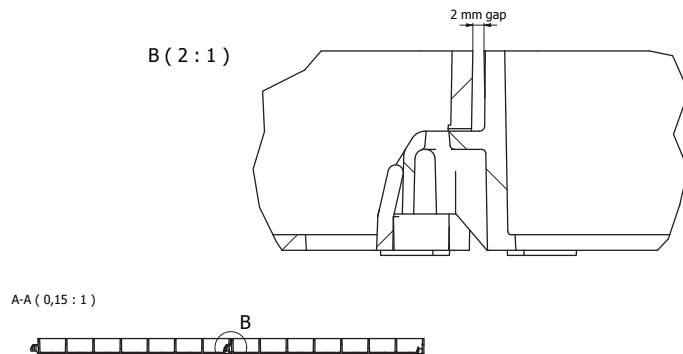
Ogni griglia ha un sistema di interblocco a scatto su ogni parte, al fine di collegare i pannelli e creare una superficie continua, che diventa completamente invisibile una volta riempito con aggregati, ghiaia o erba.
