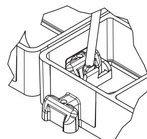
Il sistema di interblocco è un sistema resistente che garantisce una connessione perfetta e stabile sull'intera superficie. In caso di sblocco di alcune griglie, è necessario un strumento che funge da leva, come un cacciavite a testa piatta comune. Il processo è molto semplice:
